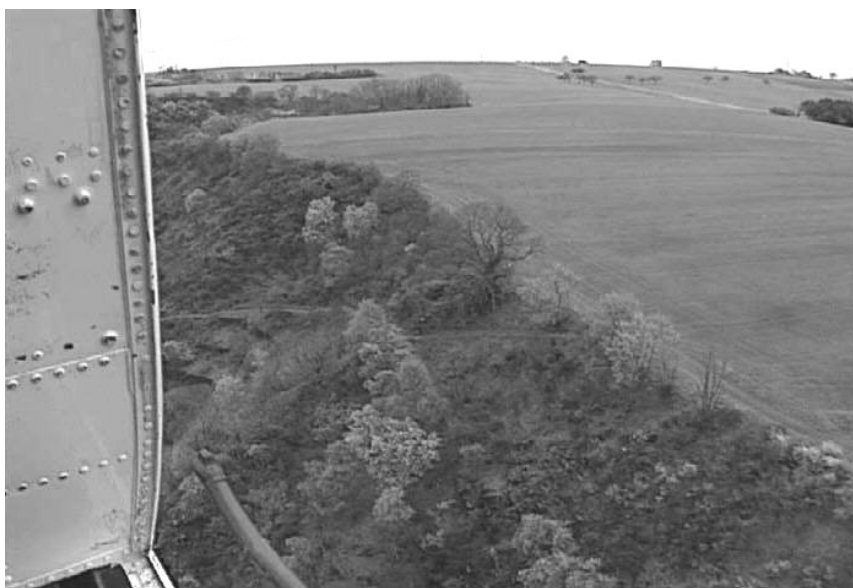
Abb. 1.4: Zum steilen Talhang gerichtete Ackerfurchen. Oberflächenwasser, vor allem nach Starkregen, kann gezielt in den Steilhang eindringen
