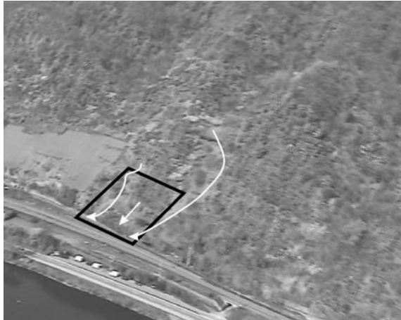
Abb. 1.3: Durch den Einsturz von Weinbergsmauern und nachrutschenden Bodenmassen gefährdete Bahnstrecke im Bahnhofsbereich Cochem. Die Schuttströme (Rutschungen) breiten sich nach unten und oben aus (Rechteck links: Ausschnitt Bild rechts)
